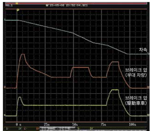
브레이크 압의 변화와 차량 속도를 동시에 기록. 속도 제어에서 적절한 브레이크 압력이 가해지고 있는지 확인.
